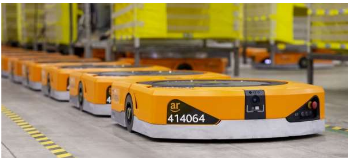
Рисунок 1.6 – АТМ производства Амазон Роботикс (Кива Системс) второе поколение, модуль грузоподъемностью 1360 кг. Источник изображения [15]
