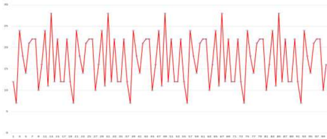
Рисунок В.5. – Исследование поведения ГА на фиксированном множестве решений при множественном перезапуске. На оси абсцисс указан номер эксперимента, на оси ординат – количество итераций, выполненных в процессе поиска решения.
