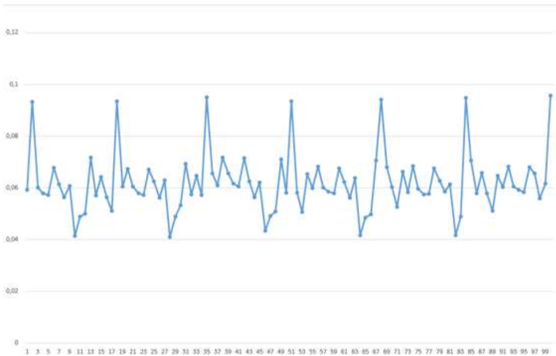
Рисунок В.6. – Исследование поведения ГА на фиксированном множестве решений при множественном перезапуске. На оси абсцисс указан номер эксперимента, на оси ординат – время процесса поиска решения.
