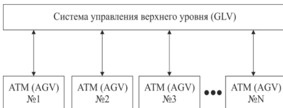
Рисунок 1.11 – Структура системы ПЭН Роботс. Источник изображения [25]
