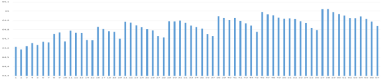
Рисунок В.1. – Профиль области поиска маршрута. Движение робота вперёд. На оси абсцисс указаны номера маршрутов, составляющих область поиска, на оси ординат – протяжённости маршрутов.
