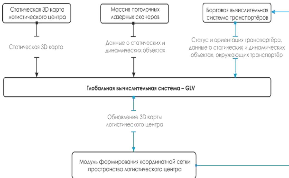
Рисунок 1.15 – Генерации 3-х мерной карты рабочего пространства и координатных сеток складского помещения
