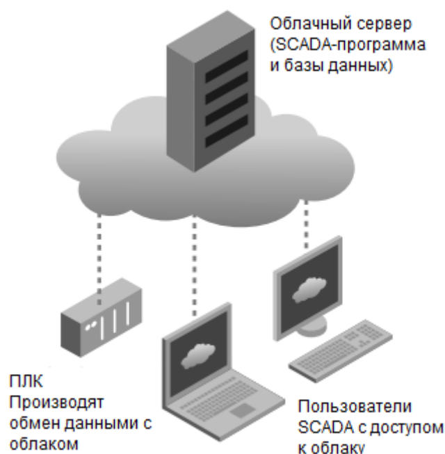
Рис. 1. Устройство облачной SCADA-системы
