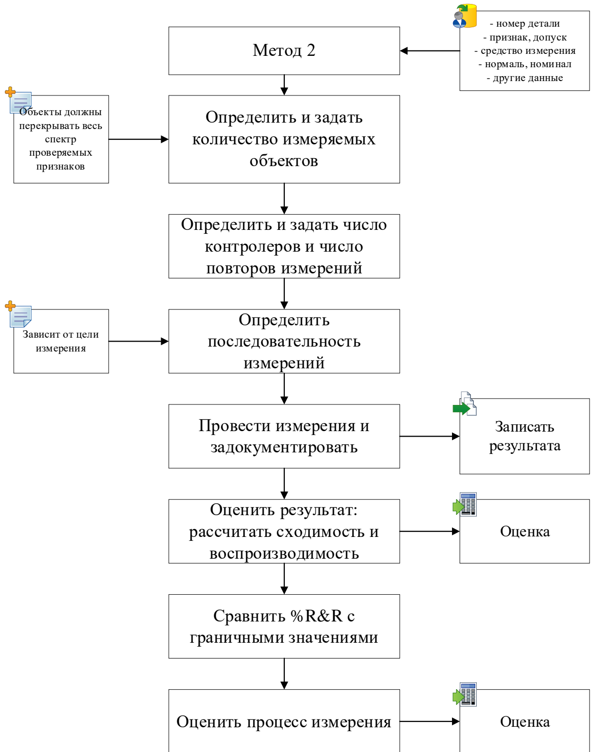
Рисунок 2.8 – Схема метода 2. Метод на проверку сходимость и воспроизводимости (с влиянием контролера)
