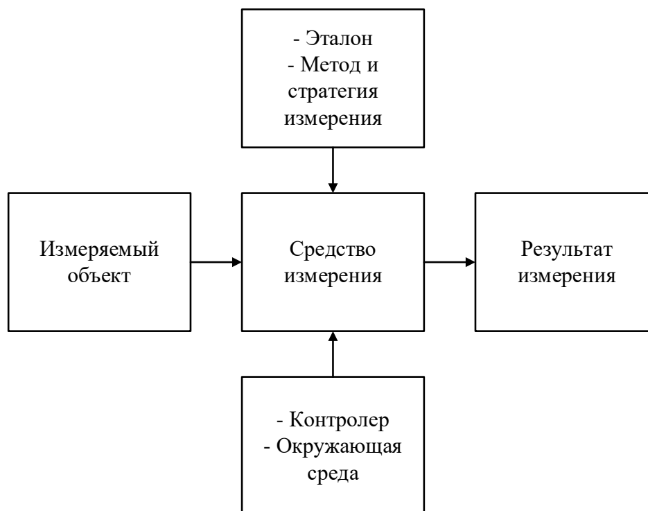
Рисунок 2.3 – Схема процесса измерения
