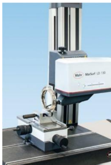
Рисунок 2.20 - Стол с рабочей поверхностью 300 мм с закрепленными на нем тисками.
