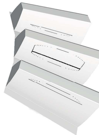
Рис. 4. Мгновенный эллипс контакта на зубе шестерни при однопарном контакте
