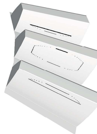
Рис. 5. Мгновенные эллипсы контакта на зубьях шестерни при двухпарном контакте на выходе из зацепления
