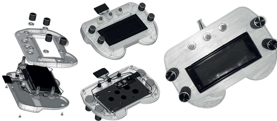
Рис. 4 – Пульт миниробота-манипулятора (модель T-Flex CAD 3D и реальное устройство)
