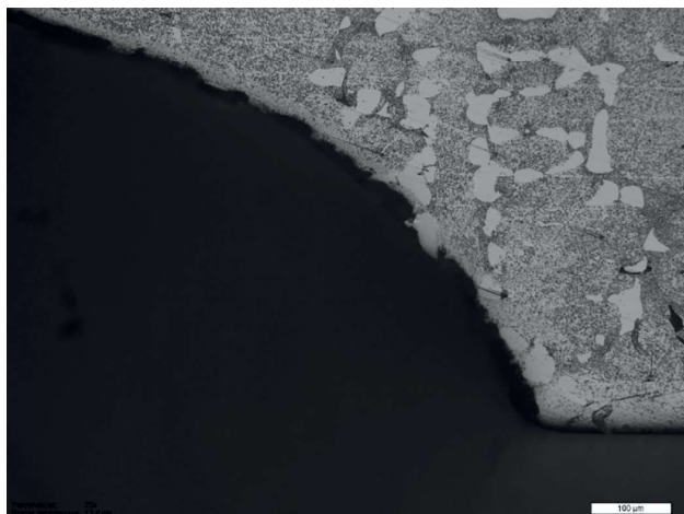
Рис. 3 – Микроструктура поверхностного слоя образца детали после фрезерования (увеличение \times 100 )
