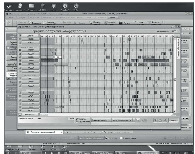
Рис. 3 – Перерасчитанное производственное расписание, визуализированное в MES-системе «ФОБОС» при моделировании ситуации обнаружения дефектных деталей в партии
