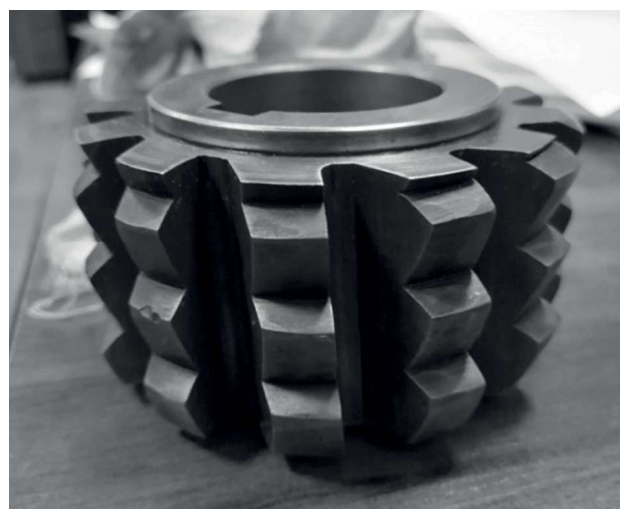
Рис. 4 — Изготовленная специальная червячная фреза для обработки винтовых стружечных канавок концевых фрез
