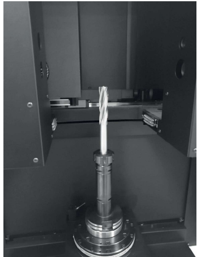
Рис. 7 – Координатно-измерительной машине Walter Helicheck Pro+
