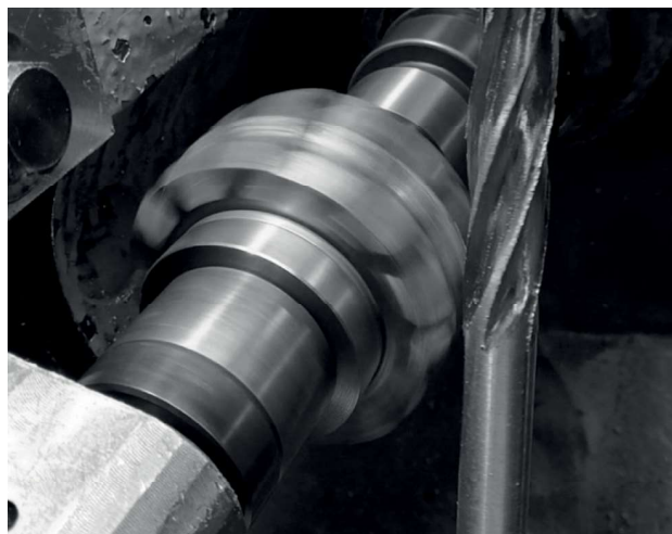
Рис. 6 — Процесс обработки винтовых канавок концевой фрезы социальной червячной фрезой
