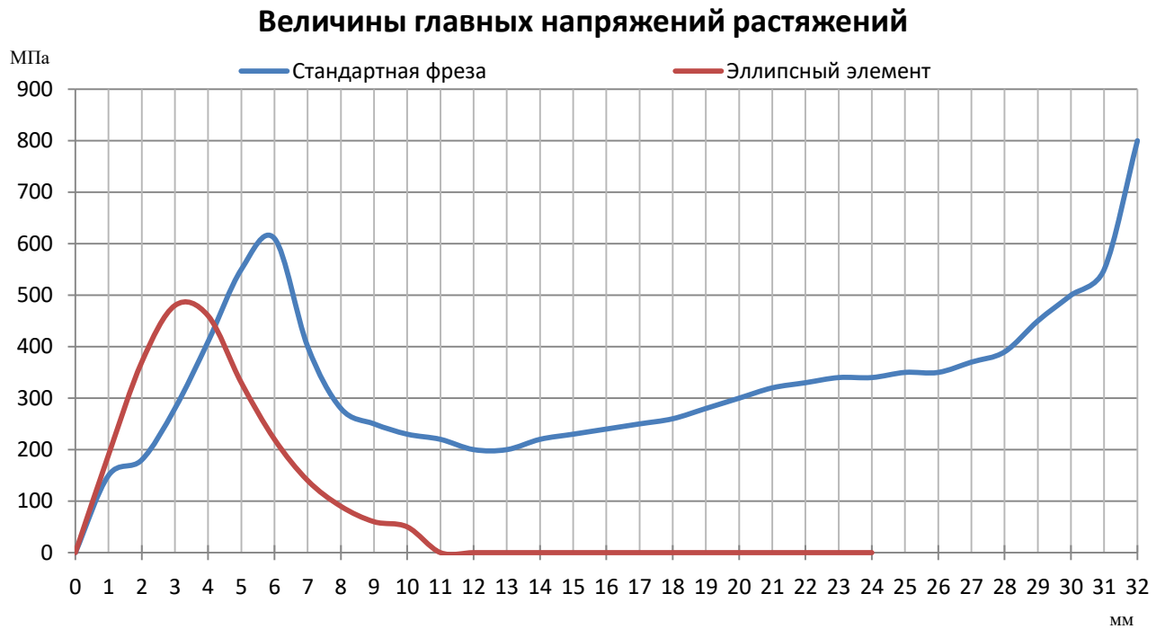
Рисунок 4.3 - Зависимости распределения главных напряжений на передней поверхности зуба стандартной и эллипсного режущего элемента сборной червячной фрезы m=14
