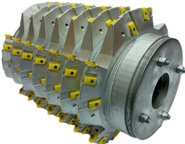
Рисунок 5.16 – Процесс изготовления конструкции сборной червячной фрезы с групповым расположением режущих элементов с применением технологий быстрого прототипирования
