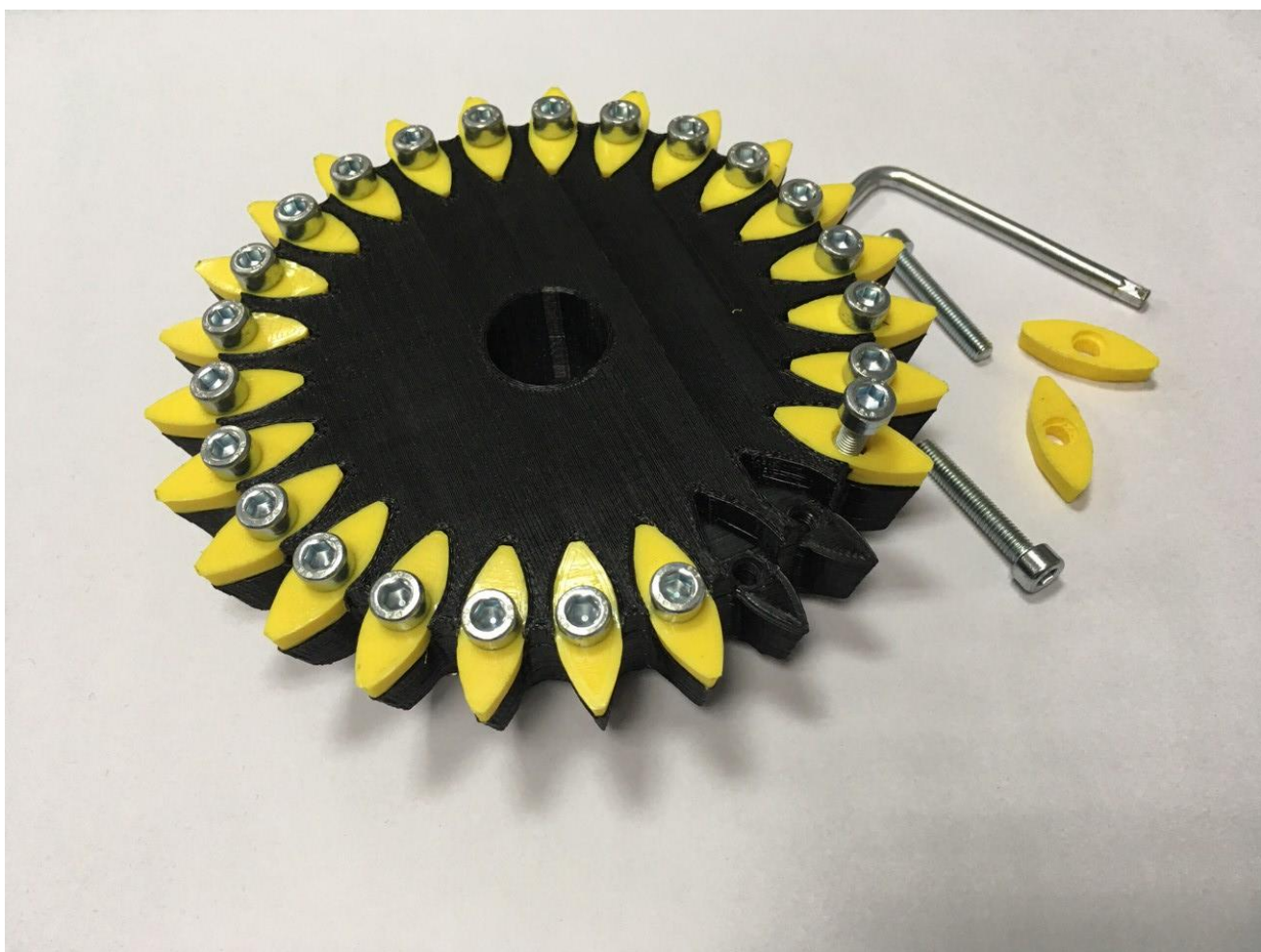
Рисунок 5.13 – Изготовление сборной конструкции долбяка с применением технологий быстрого прототипирования
