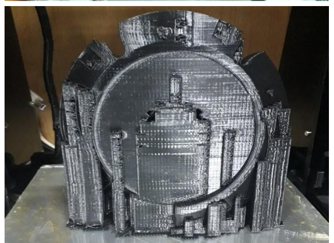
Рисунок 5.16 – Процесс изготовления конструкции сборной червячной фрезы с групповым расположением режущих элементов с применением технологий быстрого прототипирования
