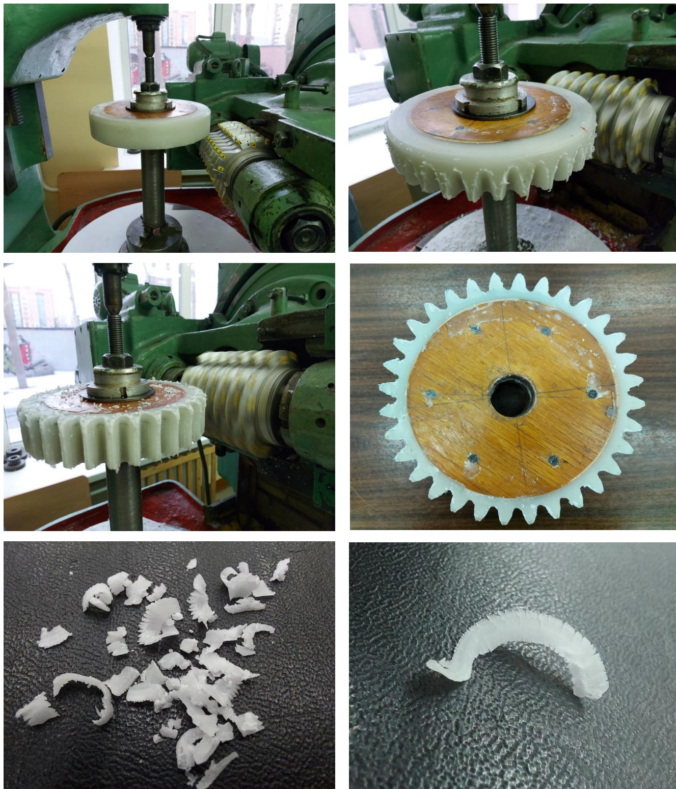
Рисунок 5.17 – Процесс нарезания зубчатого колеса разработанной сборной червячной фрезой с групповым расположением режущих элементов
