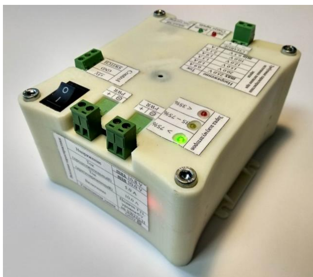
Рисунок 5.21. Прототип силового модуля (габаритные размеры: 140x100x90 мм)
