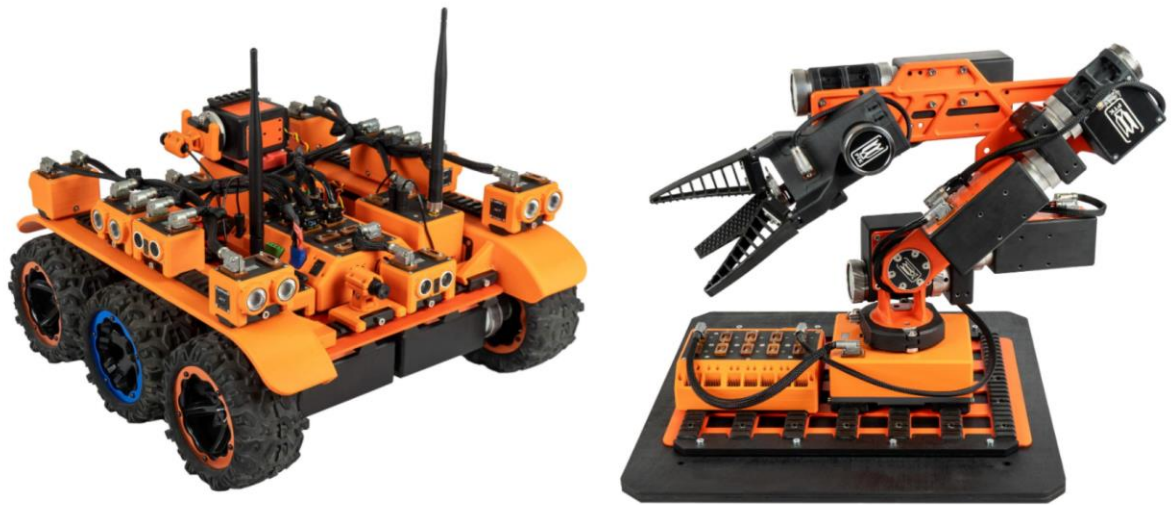
Рисунок 1.9. Учебные роботы, собранные из набора модулей: шестиколёсный робот (слева), манипулятор (справа). Источник изображения [25]
