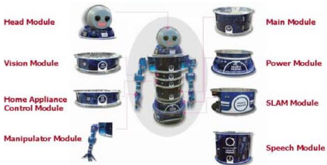
Рисунок 1.5. Mom's Friend – сервисный реконфигурируемый модульный робот.
