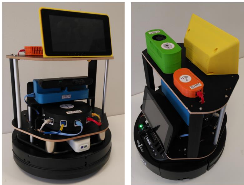
Рисунок 1.6. H-ROS Turtlebot – первый H-ROS совместимый робот. Данный робот состоит из набора аппаратных частей, совместимых со стандартными интерфейсами H-ROS. Источник изображения [111]
