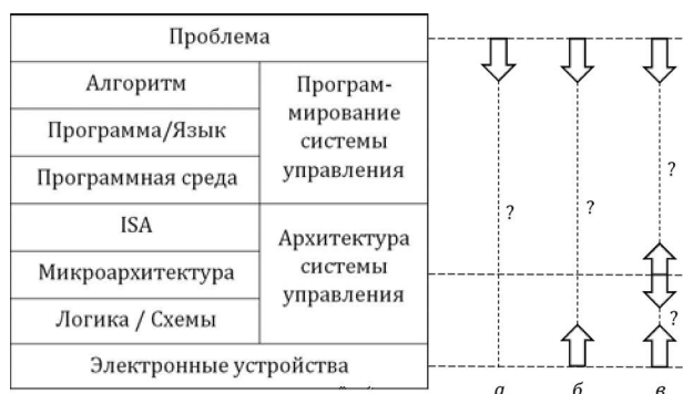
Рис. 1. Модели решения проблемы синтеза системы управления реального времени в виде последовательного многоуровневого преобразования от постановки задачи до уровня электронного устройства:
