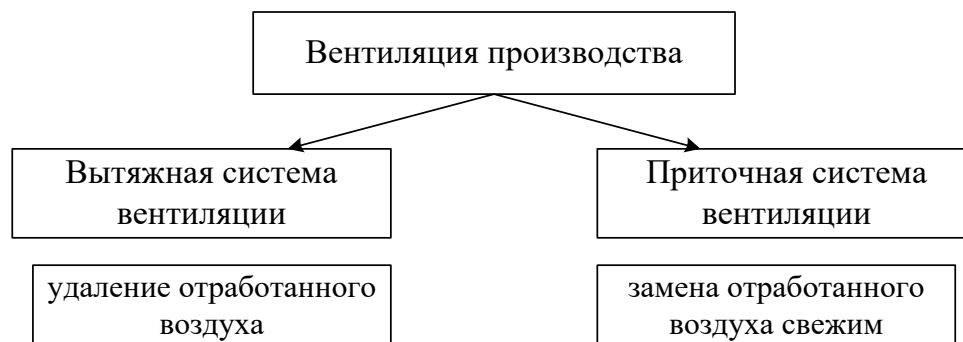
Рис. 1. Организация вентиляции производственных помещений
