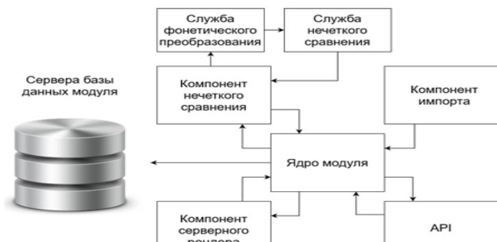
Рис. 1 – Схема модуля нечеткой идентификации
