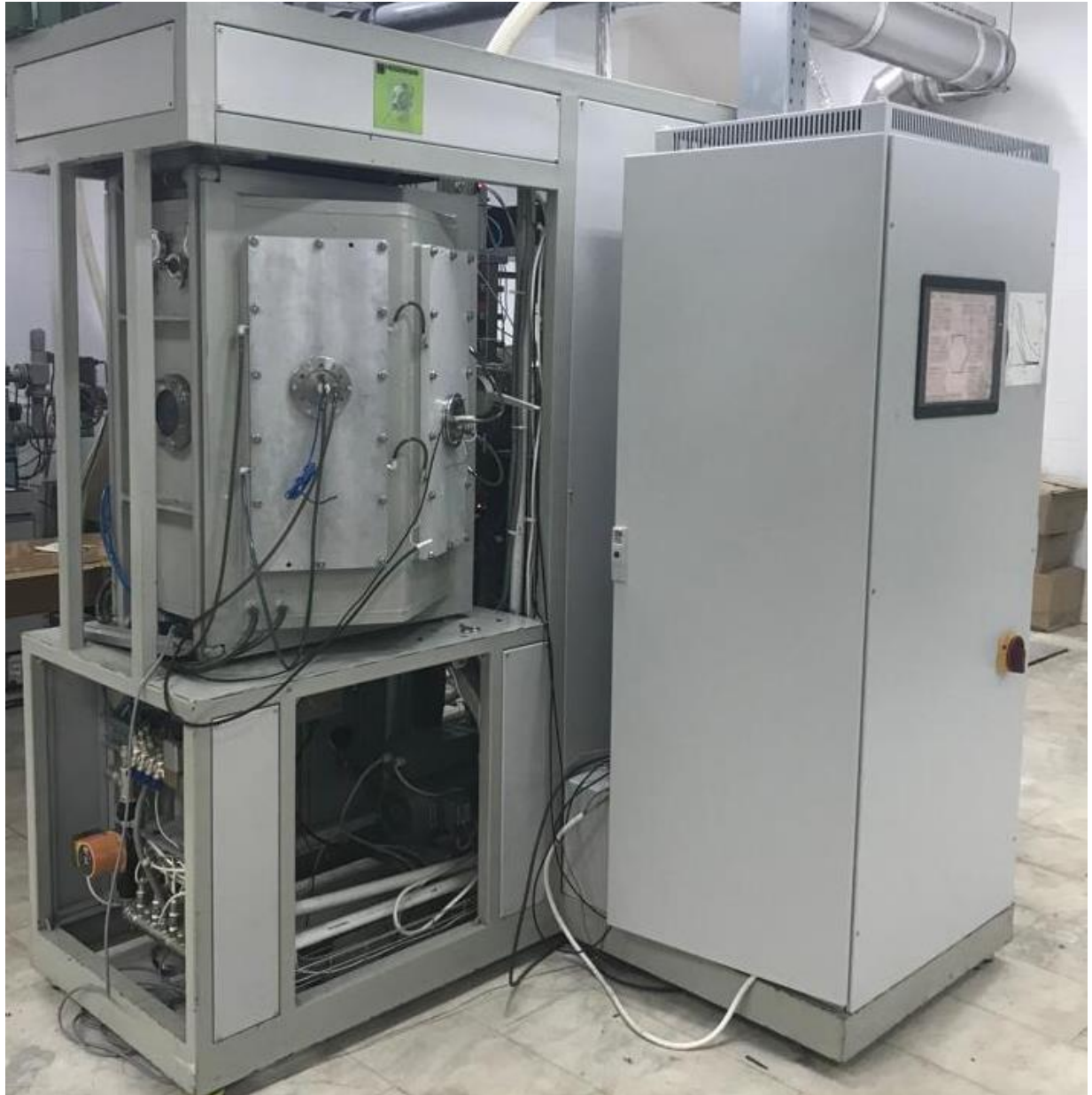
Рисунок 3.5 – Общий вид опытной технологической установки, созданной для комплексной модификации керамического инструмента
