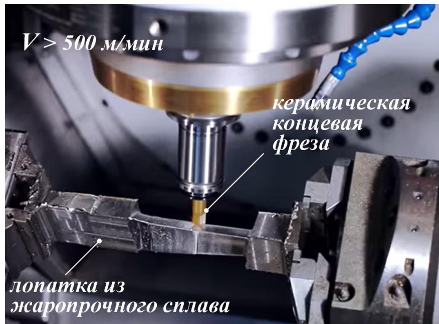
Рисунок 1.3 – Обработка деталей из жаропрочных сплавов концевыми фрезами из различных материалов: а) – изменение твердости фрез из твердого сплава и керамики с увеличением температуры резания; б) – процесс высокоскоростной обработки турбинной лопатки из никелевого сплава на многокоординатном станке с ЧПУ керамической фрезой
