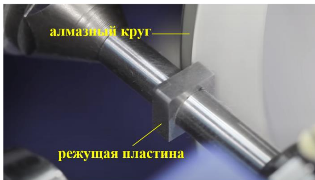
Рисунок 1.16 – Многоэтапная алмазная заточка СМКП: а) – параллельная алмазная обработка опорных (передних) поверхностей; б) – алмазная обработка боковых (задних) поверхностей и режущих кромок
