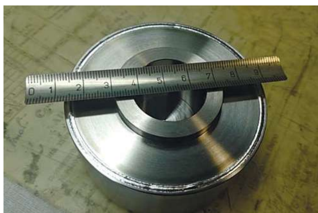
Рис. 4. Образец двигателя после электронно-лучевой сварки на представленном оборудовании
