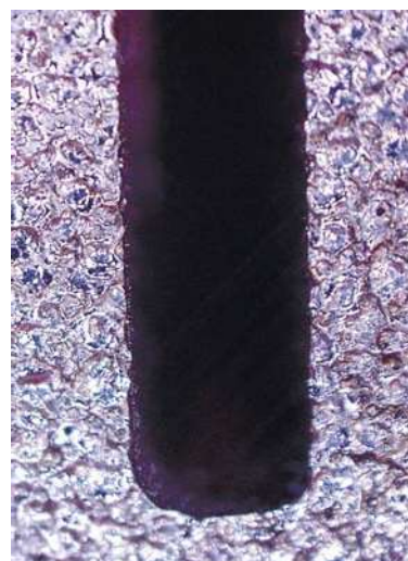
Рис. 12. Продольный паз в детали сегмент жаровой трубы камеры сгорания ГТД после АЭХШ с периодической очисткой
