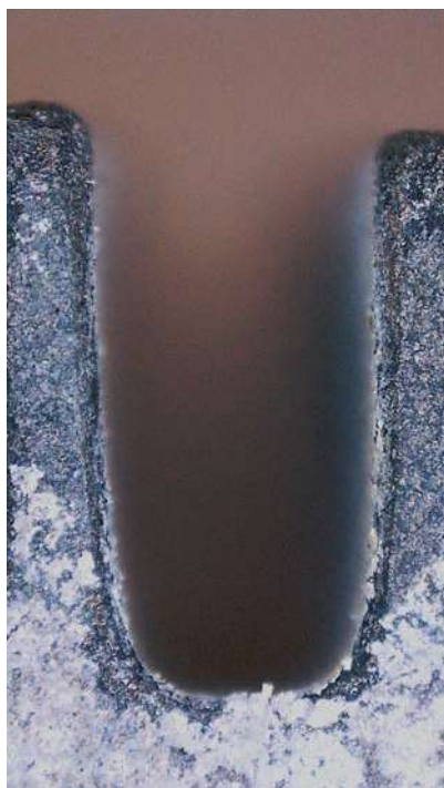
Рис. 8. Продольный паз в детали сегмент жаровой трубы камеры сгорания ГТД после АЭХШ
