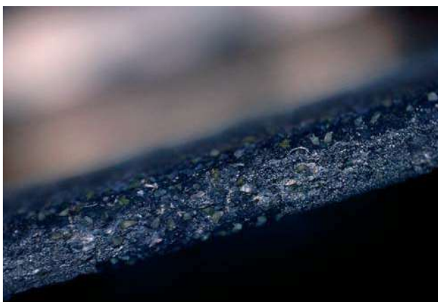
Рис. 5. Поверхность алмазного круга после АЭХШ ( V = 60 мм/мин): а) увеличение \times 10 , б) увеличение \times 100
