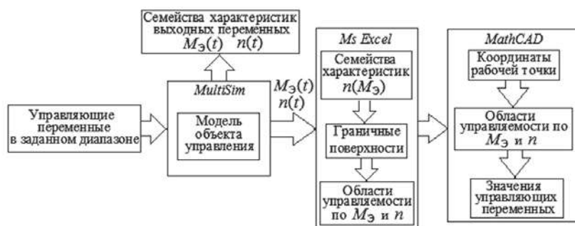
Рис. 1. Общая схема решения задачи определения значений вектора управления в области управляемости исполнительного двигателя
