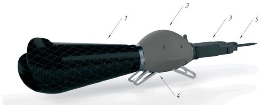
Рис. 1. Общий вид предлагаемой системы: 1 — гильза, 2 — манипулятор, 3 — рабочий орган, 4 — адаптивные опоры, 5 — инструмент
