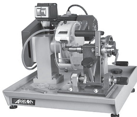
Рис. 1. Станок польской фирмы Avalon, работающий по принципу копирования
