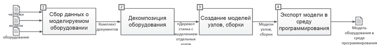
Рис. 2. Методика разработки имитационной модели станка
