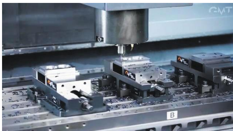
Рис. 1. Групповое парное фрезерование на фрезерном станке с ЧПУ
