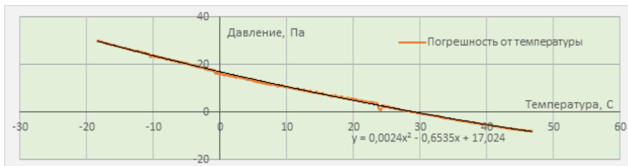
Рис. 1. Зависимость погрешности измеренного давления от температуры
