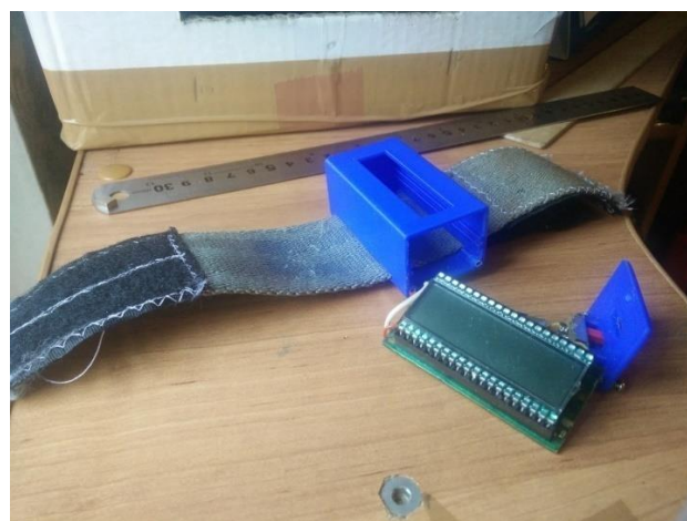
Рис. 1. Проектирование и сборка – 2-х слойная трассировка печатной платы и сборка готового устройства
