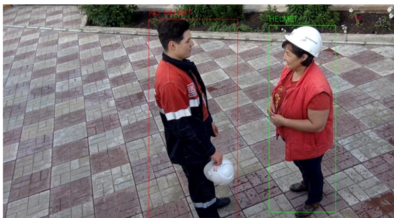
Рис. 1. Система автоматизированной детекции защитного головного убора
