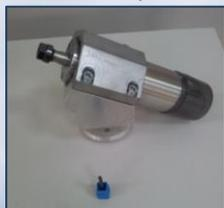
Инструмент имитации процесса механообработки фрезой. Оснащён моделью шпинделя и частотным преобразователем.
