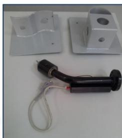
Инструмент имитации процесса электродуговой сварки с помощью свечения диодов и щелчков реле сварочной горелки, при соприкосновении сварочной проволоки с заготовкой.
