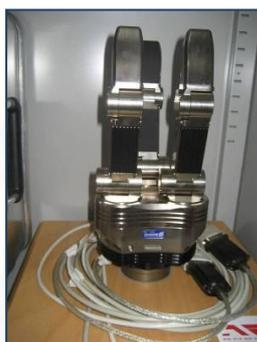
Очувствленный 3-пальцевый схват, который позволяет регулировать усилие схватывания, а также идентифицировать тип захватываемого объекта.
