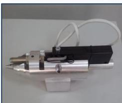
Инструмент имитации процесса лазерной резки с помощью излучательного модуля (лазера). Оснащён ультразвуковым датчиком для измерения расстояния между головой инструмента и поверхностью обрабатываемой заготовки.
